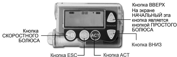
Использование кнопок помпы из экрана **НАЧАЛЬНЫЙ** описывается в таблице ниже.
