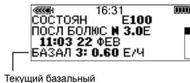
На экране СОСТОЯН отображается информация о текущей базальной дозе.
